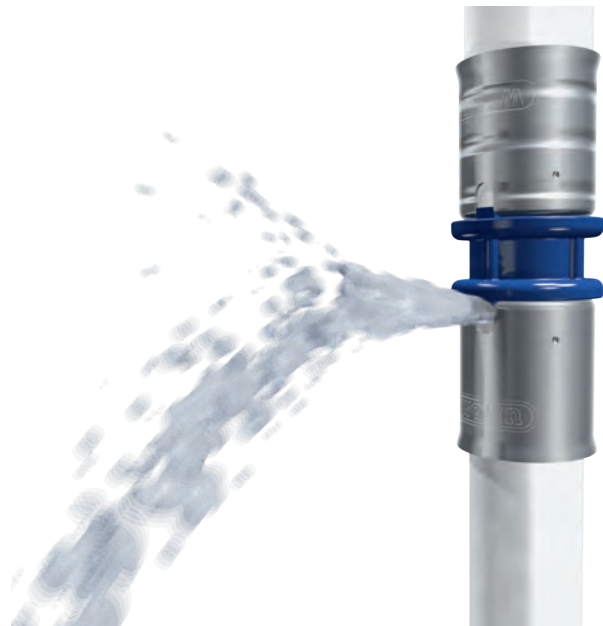
Fig. 4: Sicurezza attraverso soluzioni intelligenti: La funzione Leak Free garantisce che le giunzioni erroneamente non pressate vengano individuate durante i test di pressione.
