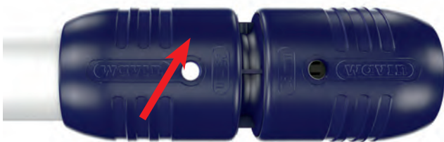
Fig. 8: Attraverso la finestra di controllo della calotta si può controllare il corretto inserimento del tubo fino alla battuta.
